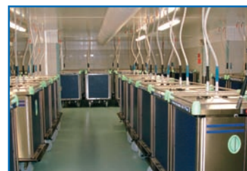
Cuve d'eau Glycolée et groupe frigorifique Glycol water tank and refrigeration unit
